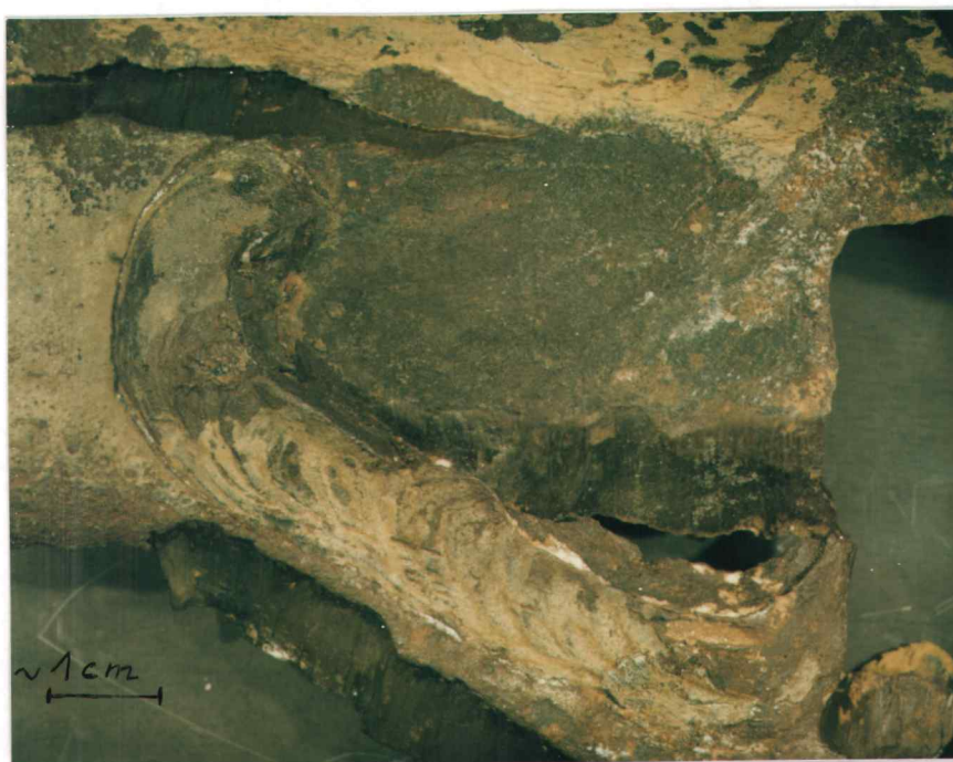
Figure n° 15b : Structure soudée cisailée
