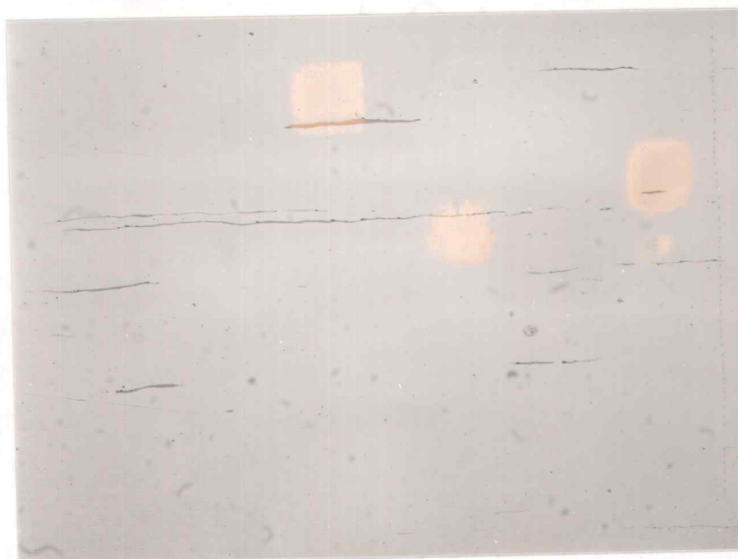
Figure n° 18 : Prélèvement selon le sens long, nombreux alignements inclusionnaires de sulfures de manganèse (Mn S)
