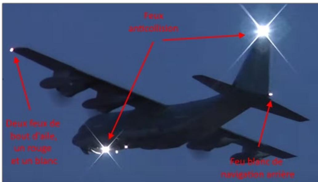
Figure 10. Feux sur C-130 Hercules vue latérale arrière
