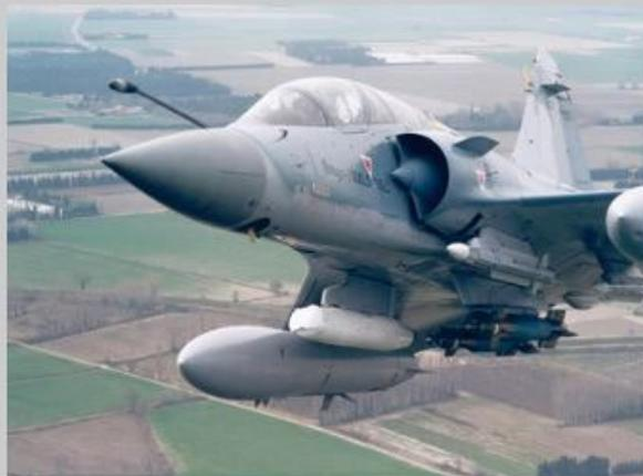
Ci-dessus : Mirage 2000-5 Mk2 une des versions export du Mirage 2000-5F. On remarque l'emport de bombes guidées laser en grappe, de MICA, d'un pod de désignation laser et de deux réservoirs supplémentaires.
