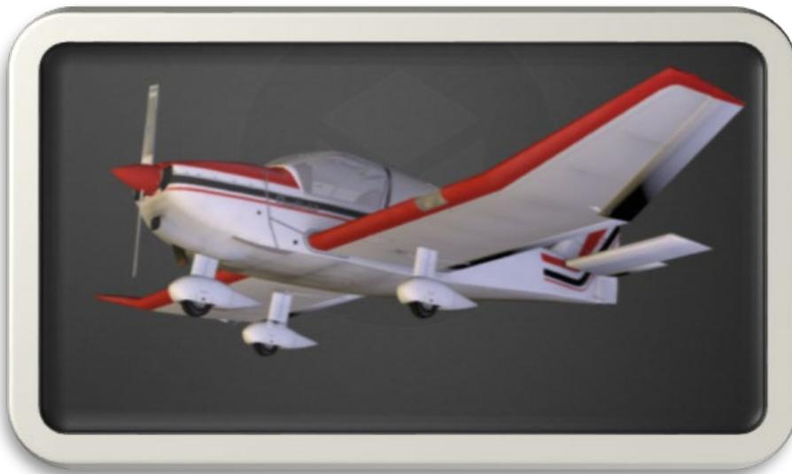
Vue en 3D de l'avion (A noter le phare d'atterrissage encastré dans l'aile gauche)
