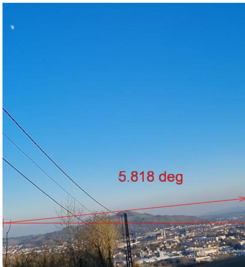
Mesure de l'inclinaison de la caméra avec IPACO
