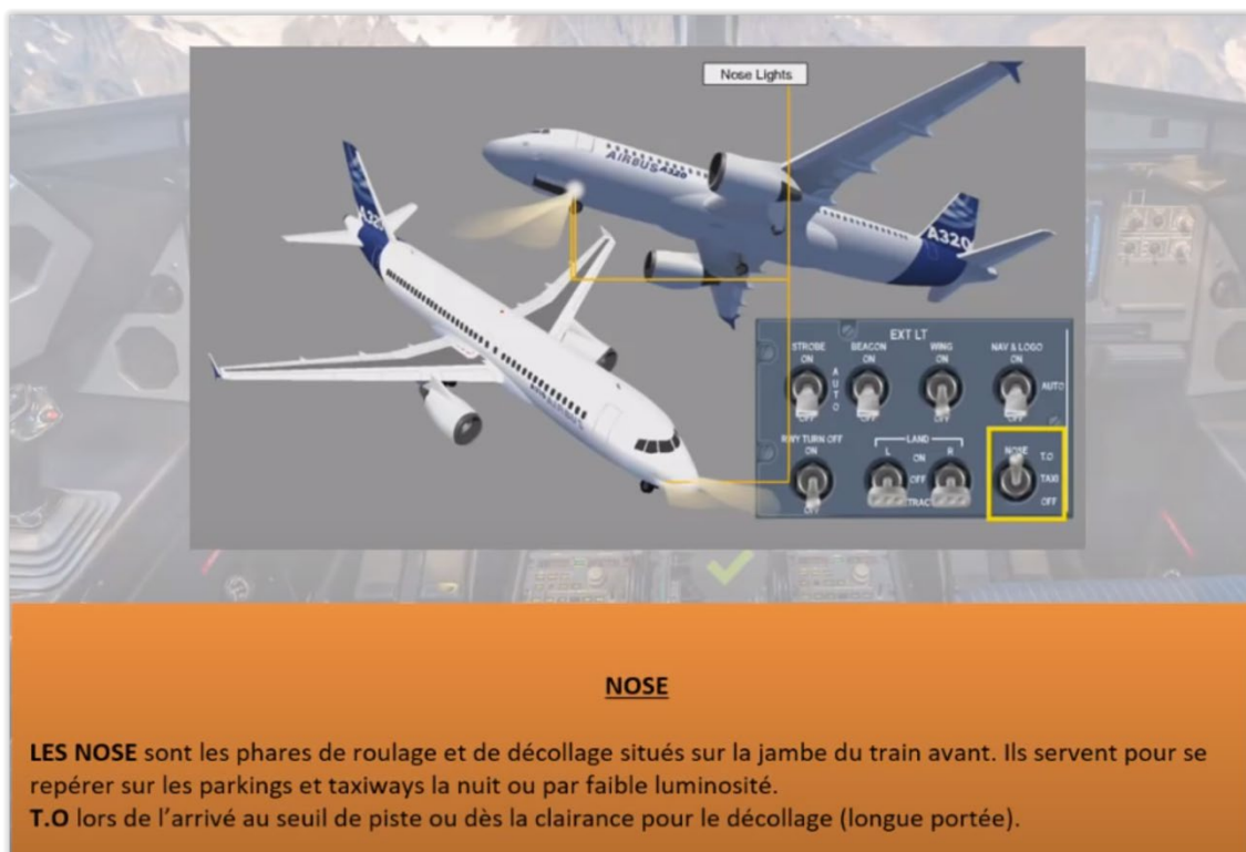
Feux « Nose », avec le T.O. longue portée sur un Airbus A320 - Source
