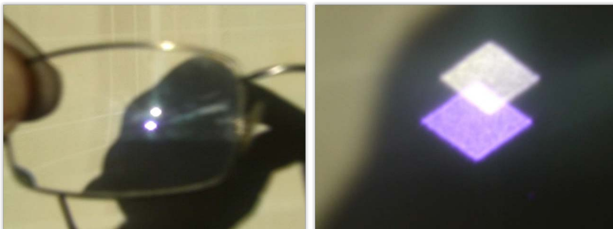
Exemple de taches lumineuses ponctuelles défocalisée en zoomant et montrant la forme du diaphragme (mise au point manuelle)
